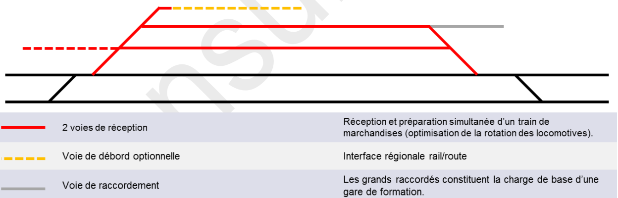
Figure 1 : structure idéale d'une gare de réception majeure
