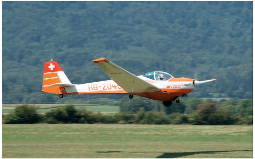
Le motoplaneur utilisé pour le projet *Vaud du ciel*. Il s'agit d'une «trottinette volante», équipé d'un moteur VW de 80 CV seulement, qui permet de se balader en l'air à 100 km/h. © Jean-Michel Zellweger
