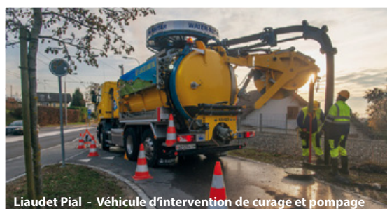
Liaudet PIAL - Véhicule d'intervention de curage et pompage
